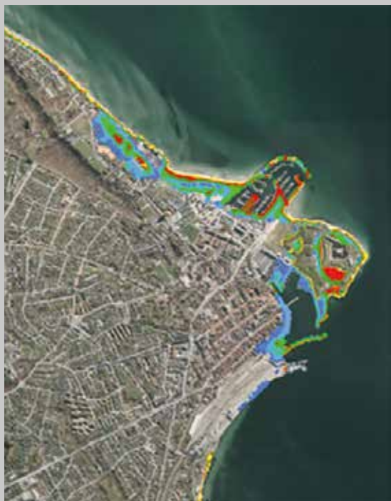
Kortudsnit med illustration af oversvømmelsesgrad i forbindelse med 500 års hændelse med 35 cm havvandsstigning
